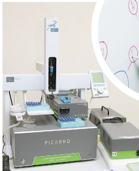
▲ Лазерный спектрометр PICARRO позволяет проводить непрерывные измерения концентрации изотопологов водяного пара
