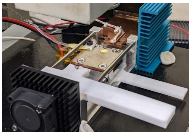
Рисунок 18 – (а) Схема и (б) фотография ячейки для охлаждения монокристаллов с заданным температурным градиентом
